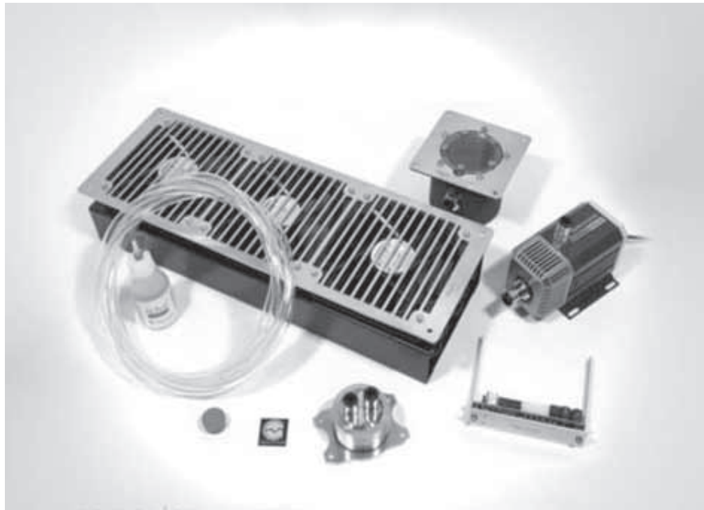
Die wichtigsten Komponenten einer PC-Wasserkühlung: CPU-Kühler, Grafikkarten-Kühler, Ausgleichbehälter, Wärmetauscher und Pumpe.
